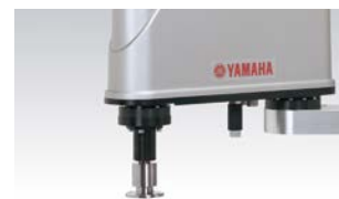
先端へのツール取付けが容易な ツールフランジオプション ※ YK250XG-YK1000XG
